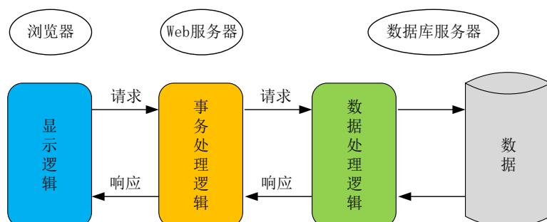
图 2-1 B/S 三层体系架构图
